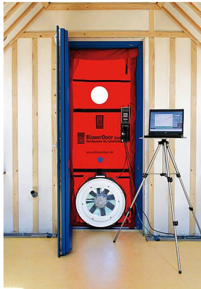
Schwachstelle Luftdichtigkeit Blower-Door-Messung
